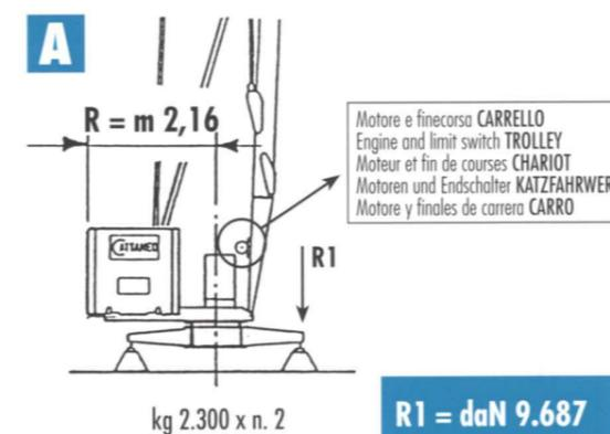
Contrappeso in lastre di cemento armato - Ferro-concrete ballast slabs
